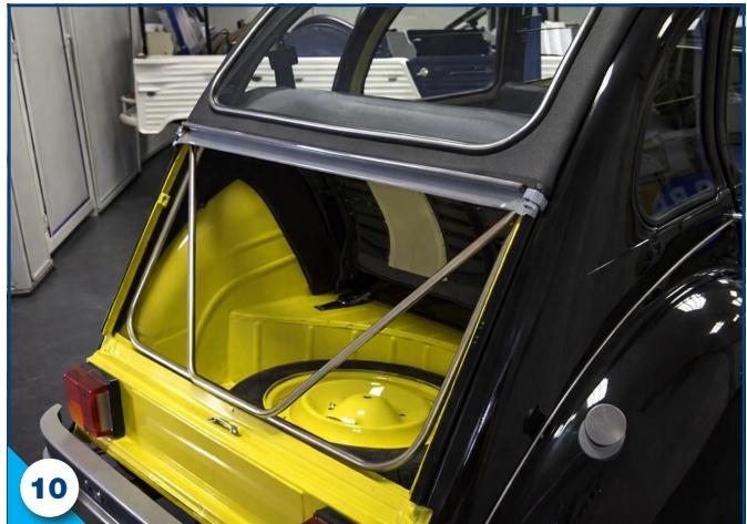
**11.** Fixez au centre de la traverse de capote avec les 2 vis métal le verrou inférieur (7) sur la partie ouverte vers l'avant du véhicule.
