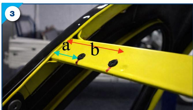
**4.** Percez les trous à gauche et à droite de la traverse (diamètre 6 mm).
