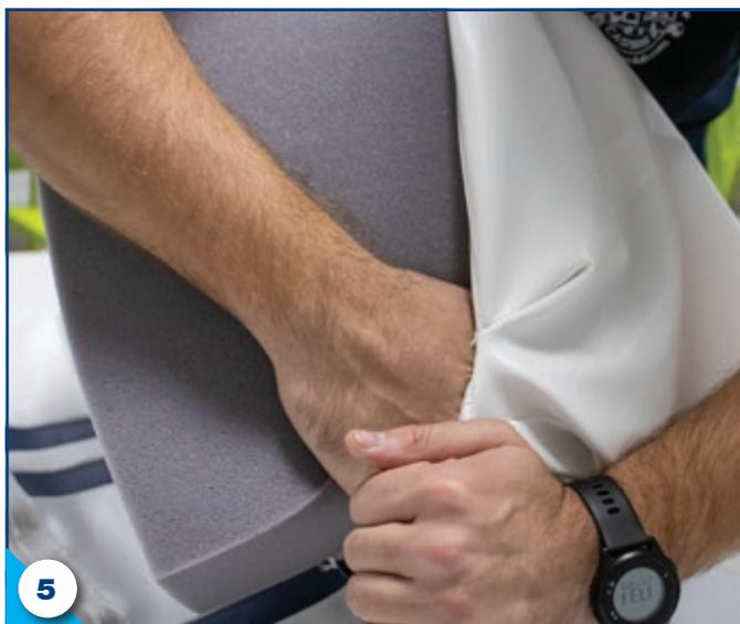
3. Une fois les deux extrémités de la mousse bien misent en place dans les coins de la garniture, aplatir la mousse.
