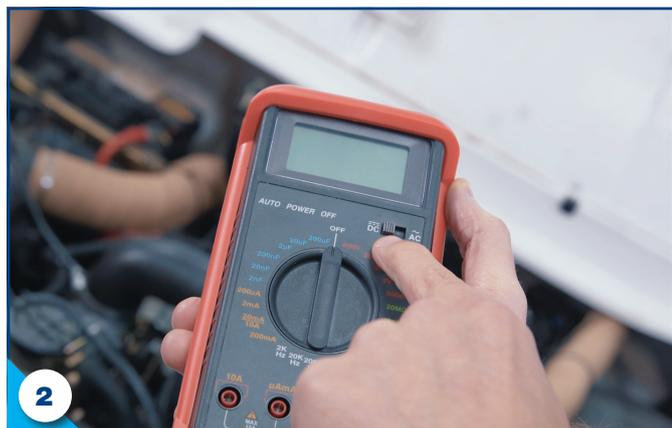
Positionner les extrémités du voltmètre sur les bornes de la batterie.
