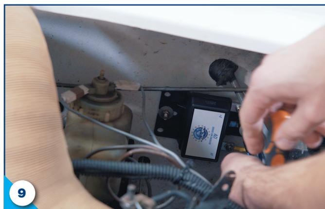
Si le véhicule est équipé d'un régulateur sur caisse, le branchement se fait via une prise. Il n'est donc pas possible de se tromper dans les branchements.
