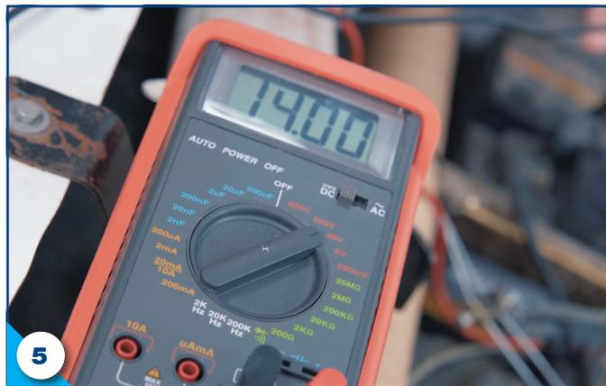
Si tel est le cas, le circuit électrique du véhicule est fonctionnel.
